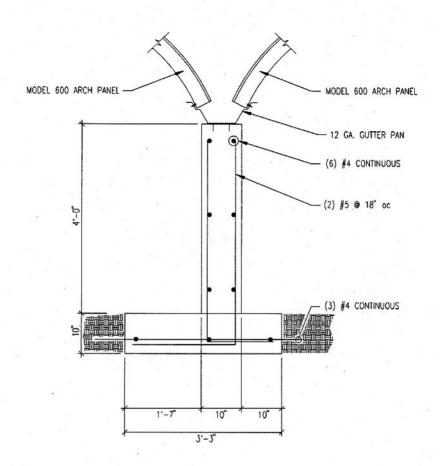
17 ARCH SIDEWALL GUTTER DETAIL
